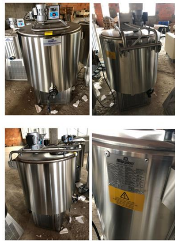
Tanques de Refrigeração
